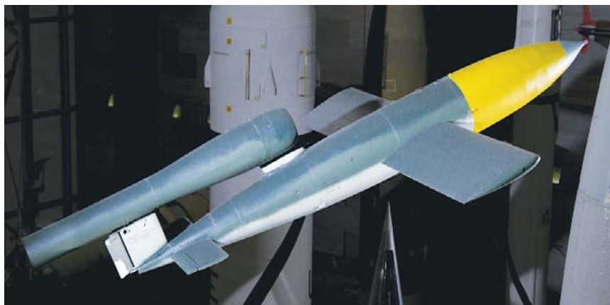
ЖУЖЖАЛКА. Германская крылатая ракета «Фау-1» имела пульсирующий воздушно-реактивный двигатель. Подобные двигатели с гораздо большей скоростью горения топлива имеют лучшие характеристики и более экономичны
